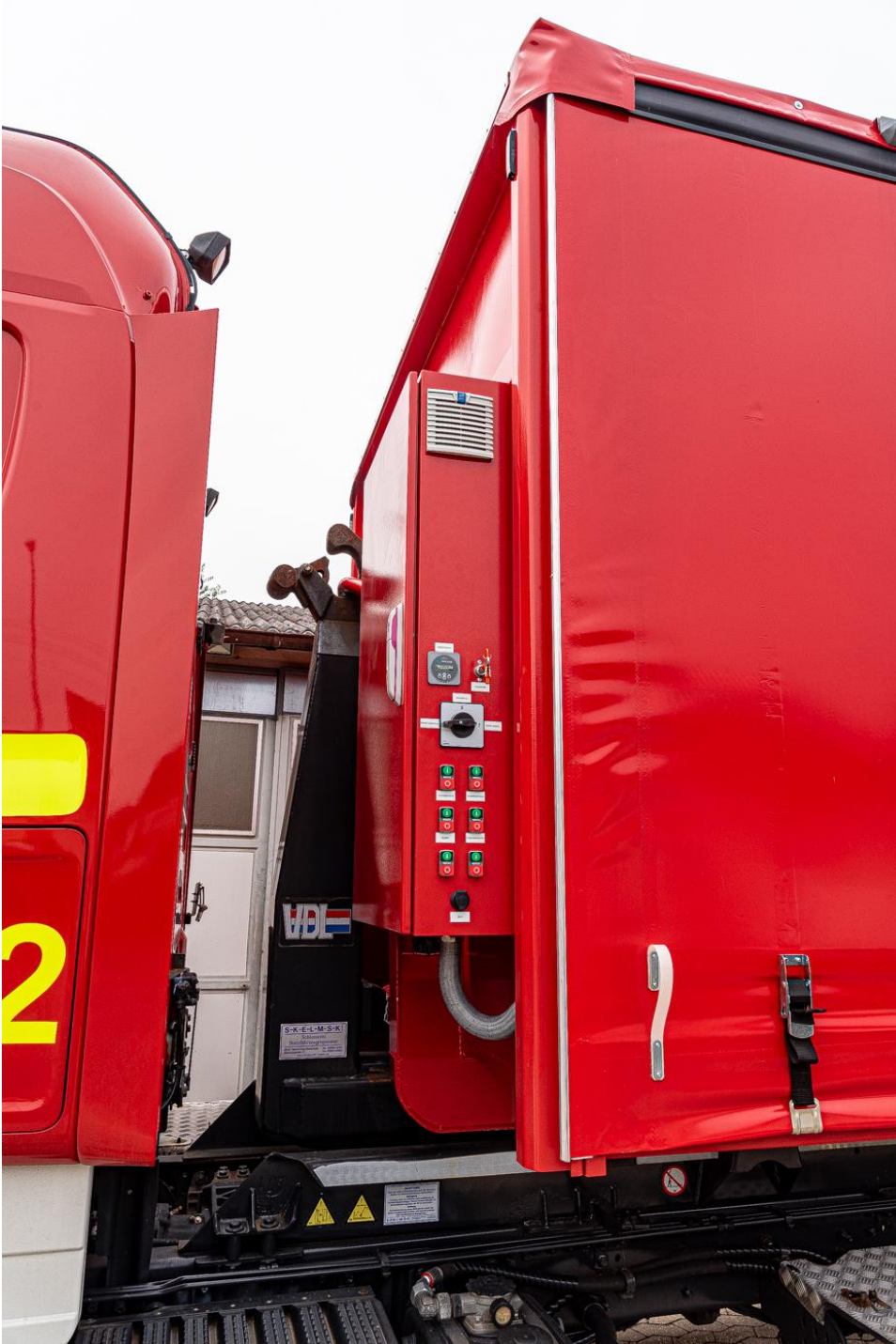
Der Container ist mit einem Batteriesystem ausgestattet, sodass die hydraulische Ladebordwand auch unabhängig vom Lastwagen benutzt werden kann. (Foto: ADRA Deutschland e.V. Andreas Lerg)
