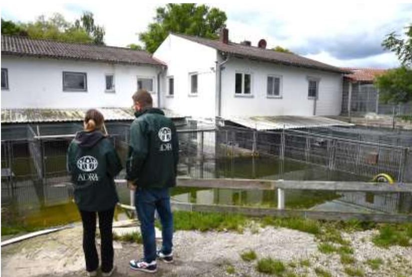
Schwer getroffen hat es das Tierheim in Hamlar. Die Keller stehen noch immer unter Wasser. Das darf bisher nicht abgepumpt werden, da durch das stark angestiegene Grundwasser Fundamente und Bodenplatte der Gebäude brechen und dann alles einstürzen könnte. Das Hochwasser muss also als „Gegenwicht“ im Keller bleiben, bis diese Gefahr nicht mehr besteht. Die Heizung ist ein Totalschaden, auch die Elektrik hat schweren Schaden genommen. (Foto: ADRA Deutschland e.V. Andreas Lerg)
